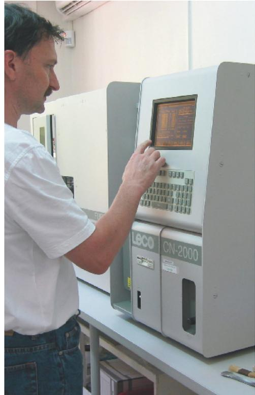
Appareil d'analyse des teneurs en N et C.
