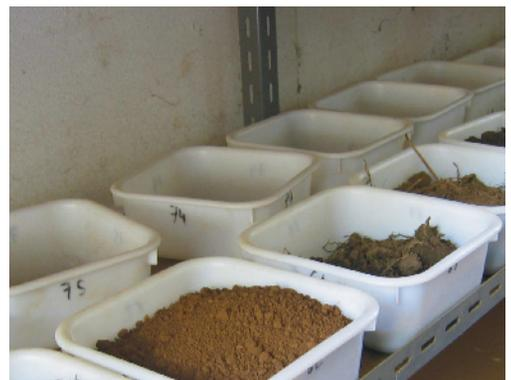
Arrivée des échantillons de terre au laboratoire et séchage en cuvettes. © V. van de Kerchove
