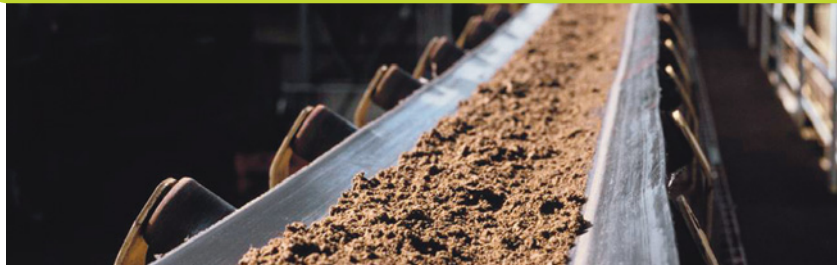
Tapis d'évacuation des écumes dans l'usine. © CEDUS
